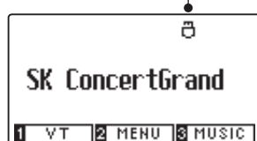
连接 USB 记忆设备时的显示状态
